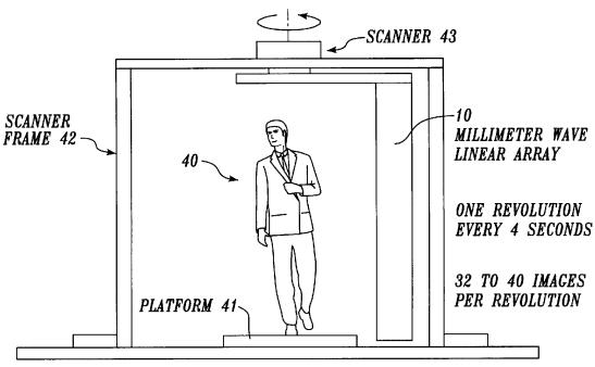
ARRAY ROTATES AROUND PASSENGER
