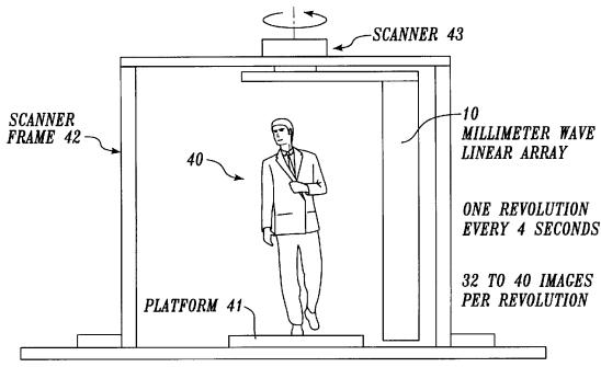
ARRAY ROTATES AROUND PASSENCER
